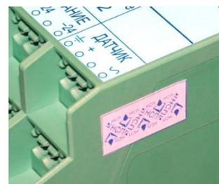
Места пломбирования блока обработки влагомеров BCH-2
