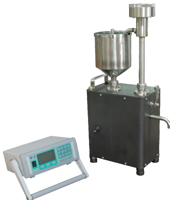
Рисунок 1 – Общий вид влагомеров ВСН-Л-01 и ВСН-Л-02.
