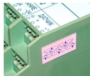
Места пломбирования блока обработки влагомеров BCH-2
