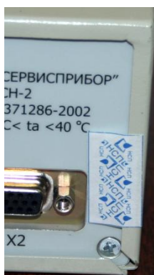
Места пломбирования блока обработки влагомеров BCH-2
