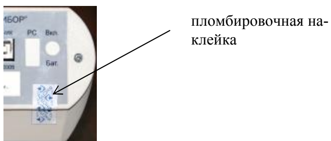
Рисунок 3 – Схема пломбирования солемеров
