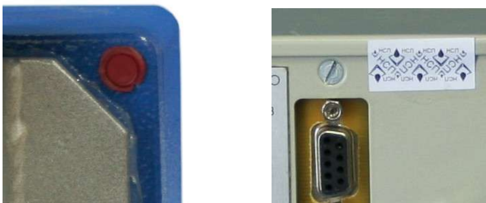
Рисунок 3 - Места пломбировка влагомера МВН-1
